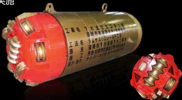
ラムサスSDシールド正面
