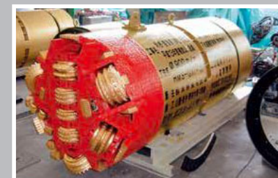
巨礫対応GXヘッド掘進機
